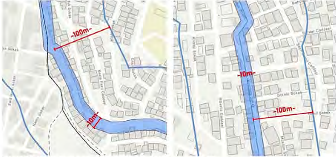
Şekil 20: Dere tampon bölge içerisindeki binalar.[30]
